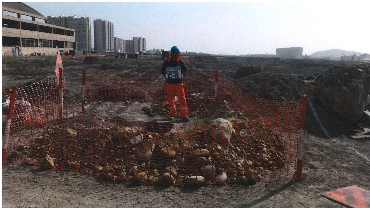
CALICATA C-16. SE APRECIAN LOS SUELOS EXTRAÍDOS DE LA EXCAVACIÓN.
