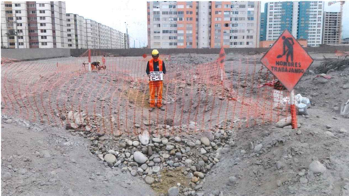
CALICATA C-4. SE OBSERVAN LOS SUELOS EXTRAÍDOS DE LA EXCAVACIÓN.
