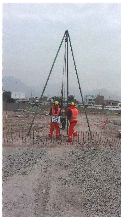
AUSCULTACIÓN CON CONO DE PECK CP-1 MAGGIE MARTINELLI MONTOYA INGENIERA CIVIL Reg. CIP N° 26250
